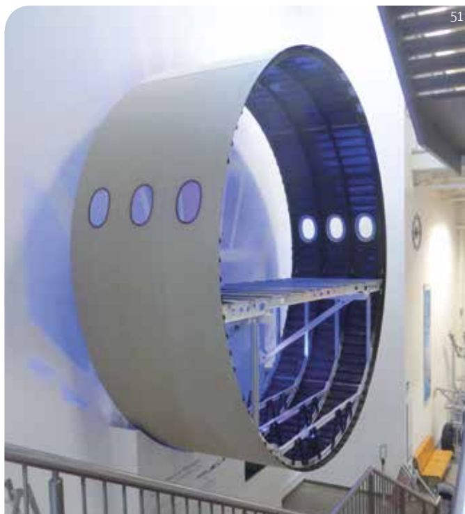
Ein Rumpfteil des AIRBUS A350 aus Carbon
